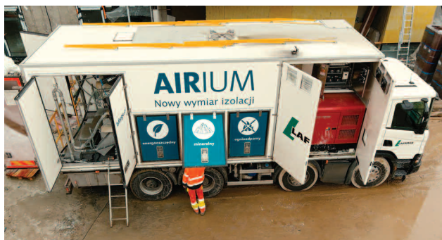
Dzięki mobilnej wytwórni AIRIUM Truck mineralną pianę termoizolacyjną AIRIUM produkuje się bezpośrednio na budowie
